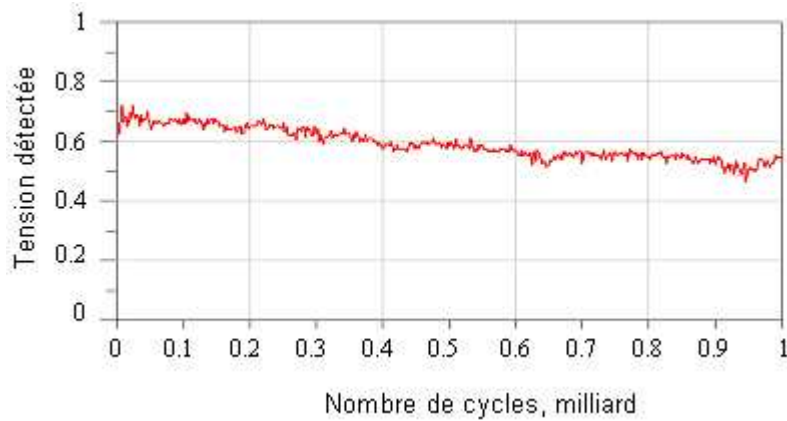
Figure 3.20 : Tension détectée sur la réponse en réflexion d'une cellule élémentaire en commutation à chaud sous 5 W
