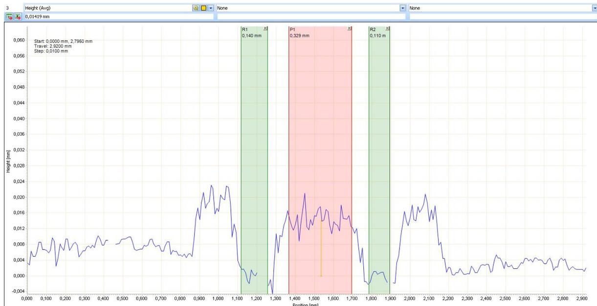
Figure VI-22 : Relevé de l'épaisseur de métallisation d'une couche, au niveau d'une ligne, avant assemblage, réalisé par VTT.
