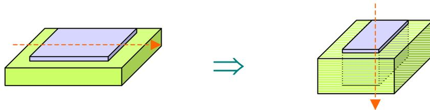
Figure III-1 : Réduction des dimensions des filtres unitaires par la création de filtres 3D.
