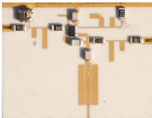
FIG. 3.38 – Photographie du premier oscillateur à fréquence fixe
