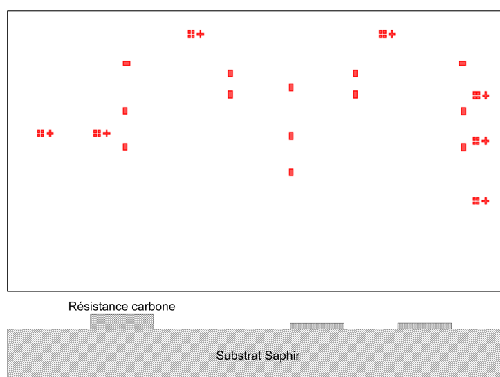
FIG. 3.45 – Couche n°2 du masque : résistances de polarisation
