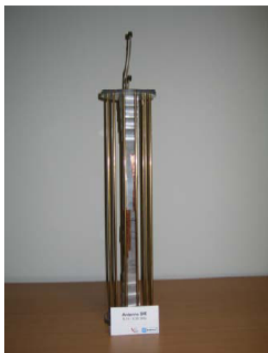
Figure I-33 : Antenne BIEM coaxiale omnidirectionnelle et ses diagrammes de rayonnement
