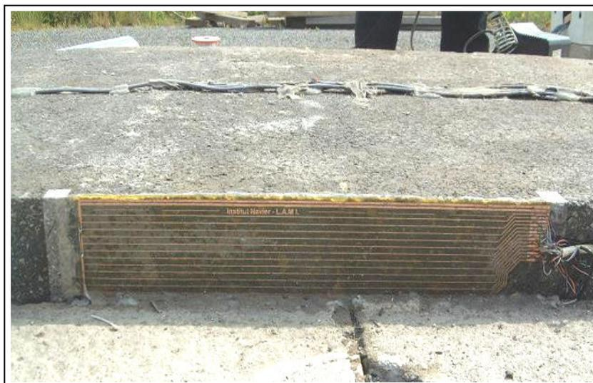
Figure 2.37 – Jauges de fissuration de 30 cm de longueur
