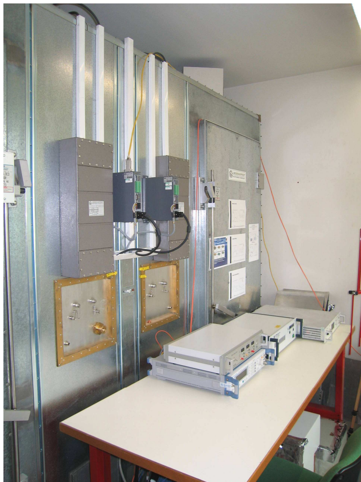
Figure 1 : Vue extérieure de la CRBM de Xlim sur laquelle on aperçoit les divers appareils de mesure, ainsi que les ports permettant la communication intérieur ↔ extérieur
