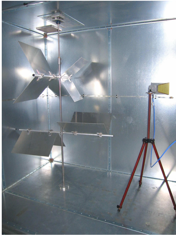
Figure 2 : Vue intérieure de la CRBM de Xlim, sur laquelle on constate la métallisation complète des parois. On aperçoit le brasseur sur la gauche ainsi que son axe de rotation et sur la droite, on remarque la présence du système d'émission.
