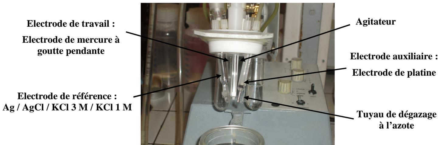
**Figure 5: Montage à trois électrodes**
