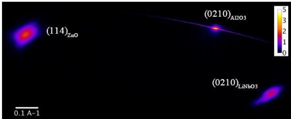
Figure 17 : nœuds (02.10) d'Al<sub>2</sub>O<sub>3</sub> et LiNbO<sub>3</sub> et (11.4) de ZnO pour LN157
