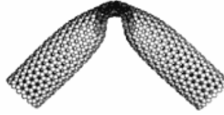
Figure 28 : Des propriétés mécaniques hors du commun : très grande élasticité (module d'élasticité > 1000 GPa), très grande flexibilité (crack stress : 45 GPa)
