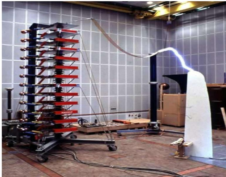
Fig. 13 : Générateur de Marx 12 étages -  $C = 0.6 \mu\text{F}$  - 100 kV - 1.2 MV - 36 kJ
