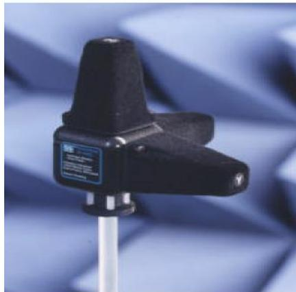
Fig. 36 : Capteur de champ triaxial
