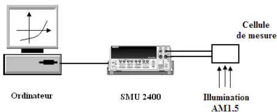
Figure 18 : Banc de caractérisations I(V) et I(V,t)
