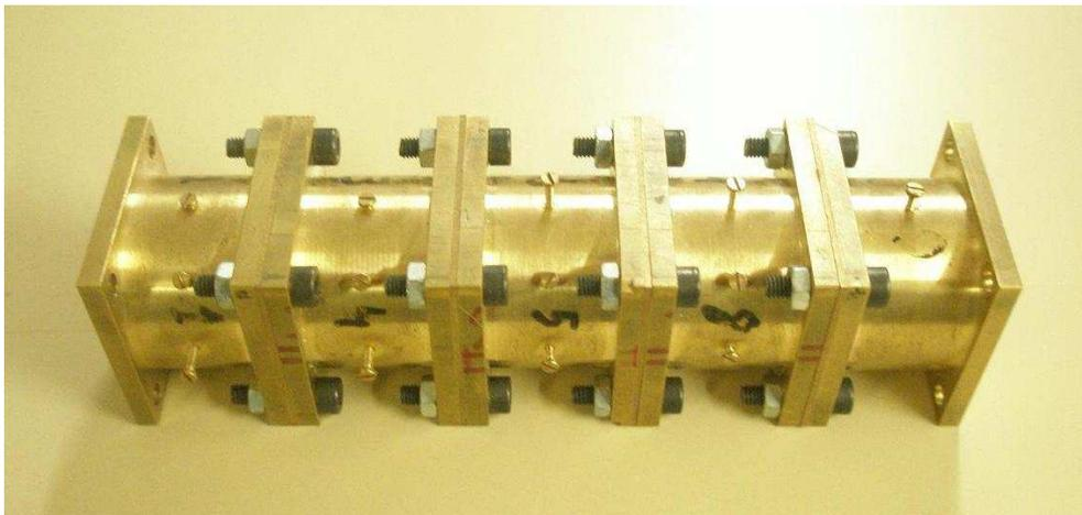
Figure III.13 : Maquette du filtre bi bande à fonction de transfert dissymétrique (9-3).
