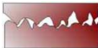
Figure I.22 Phénomène d'usure d'un microcontact métal-métal [I-45].
