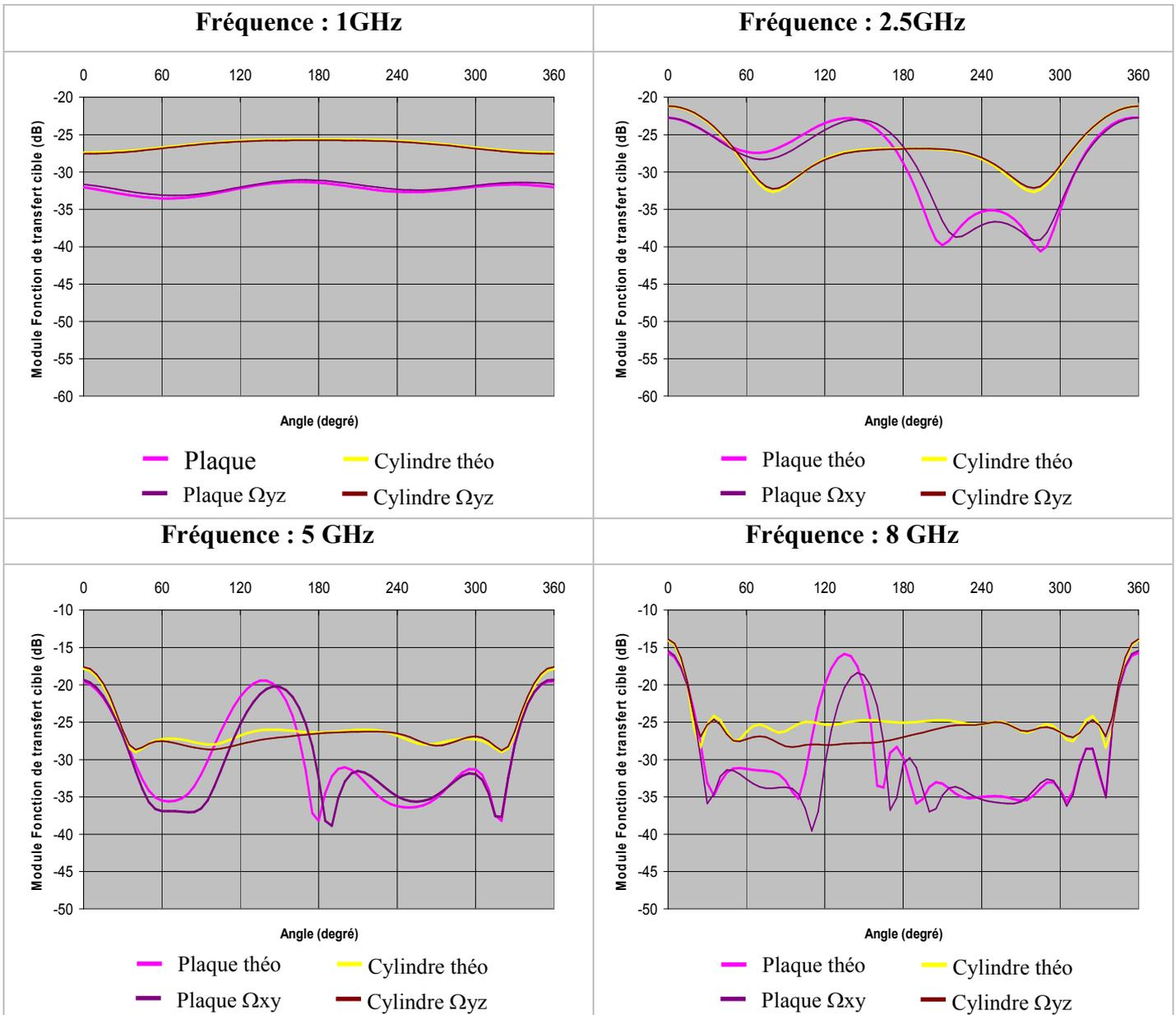
Figure II- 24 : Fonction de transfert des cibles en fonction de leurs positionnements
