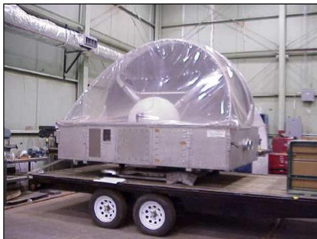
Figure I- 19 : Exemple de source utilisant une seule antenne : Projet JOLT avec une antenne Half IRA (diamètre de l'antenne : 3,05m).
