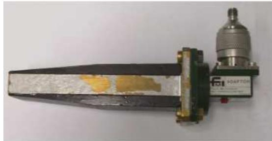
Figure 46: Photo du guide ouvert bande X et à la transition associée
