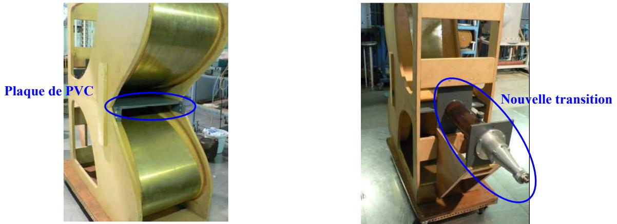
Figure IV- 19 : Antenne Valentine HT modifiée par le LGE
