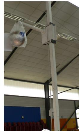
Antenne de réception protégée du couplage direct de la source rayonnante par un grillage
