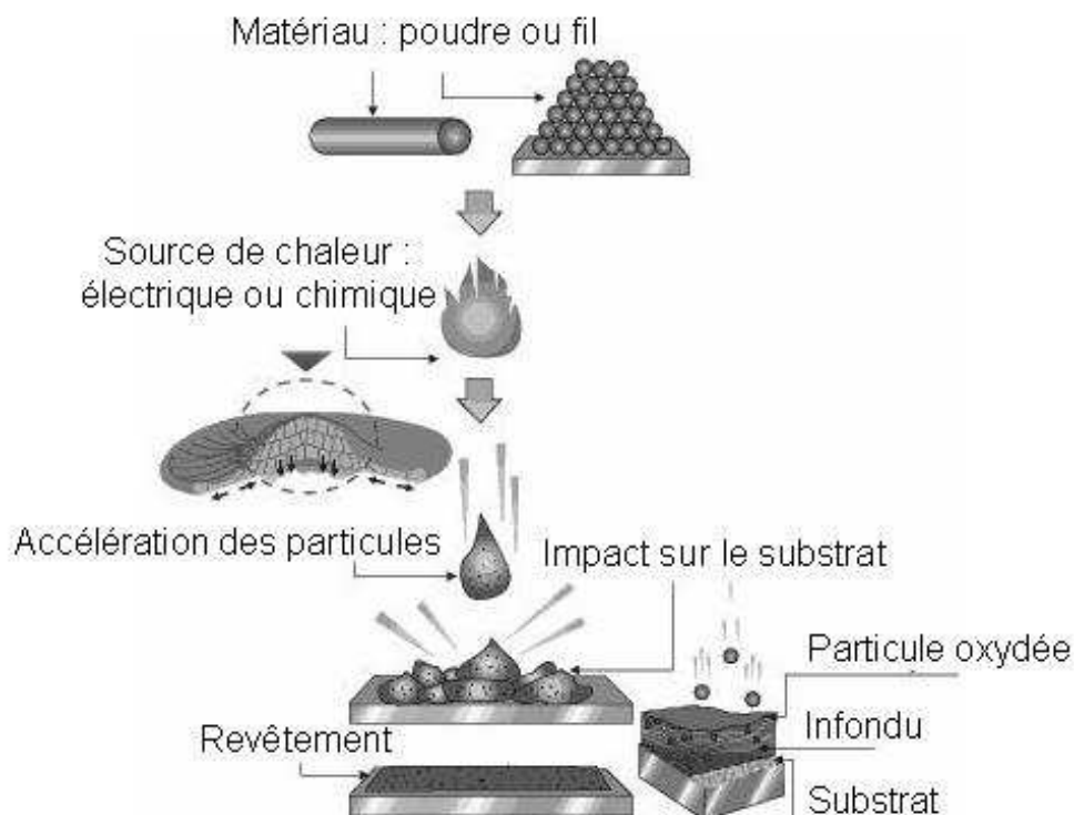
Figure 7 : Principe de la projection thermique (d'après [32]).
