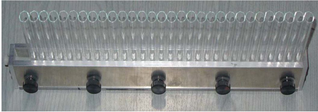
Figure IV-61 : Dispositif de récupération de poudre au dessous de l'injecteur
