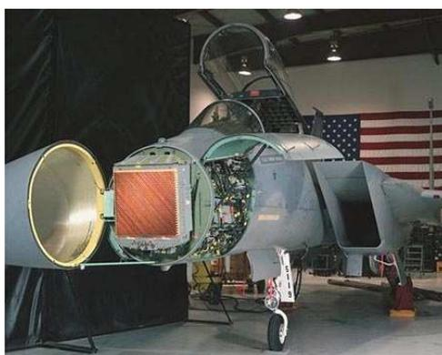
FIG. 1.7 – Avion de chasse (F-15C modifié), équipé d'une antenne active logée dans son radome
