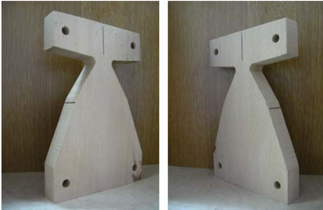
Figure III.3.3. Epreuve bois réelle (Hêtre).
