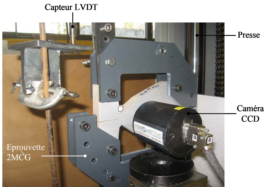
Figure III.3.4. Dispositif expérimental en mode I
