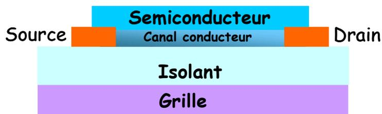
Figure 18a : Schéma d'un transistor en géométrie « bottom contact » avec localisation du canal.
