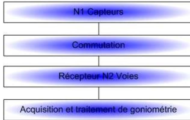
Figure 1 : Architecture fonctionnelle d'un radiogoniomètre
