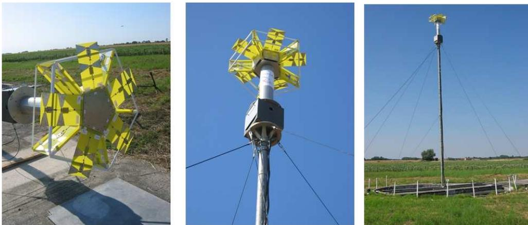
Figure 75 : Installation du réseau d'antennes directives sur la base de Coulommiers
