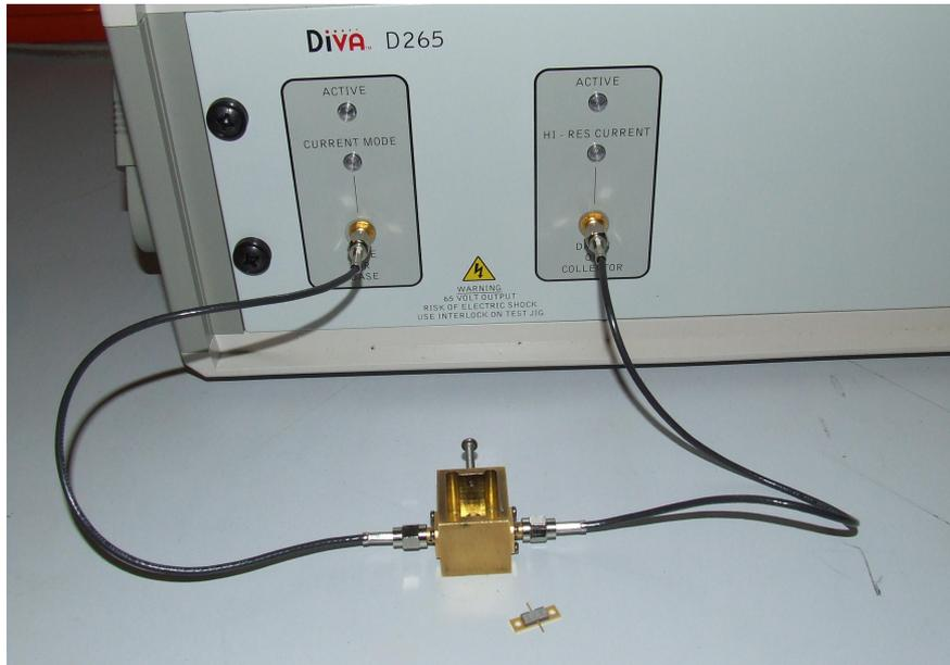
Figure 87. Cellule de test pour BMH60 reliée au banc DIVA
