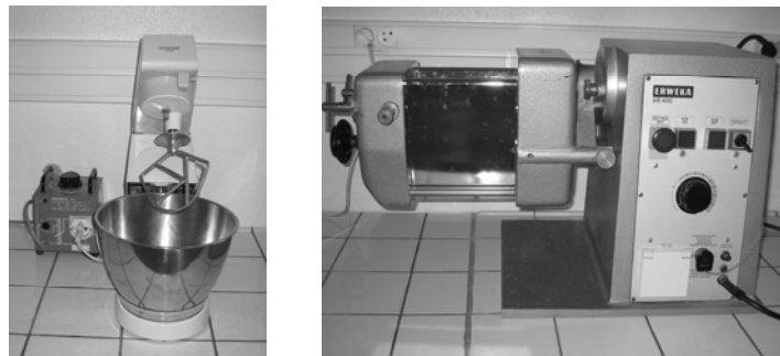
Figure 10 : Mélangeur planétaire Kenwood Chef et granulateur oscillant Erweka
