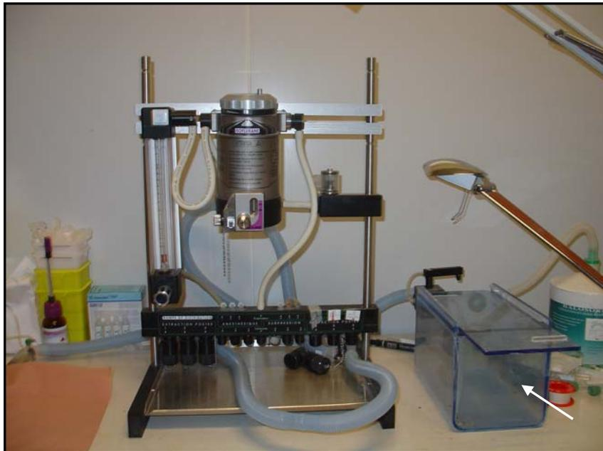
Figure 7 : Appareil d'anesthésie avec chambre d'inhalation (flèche).
