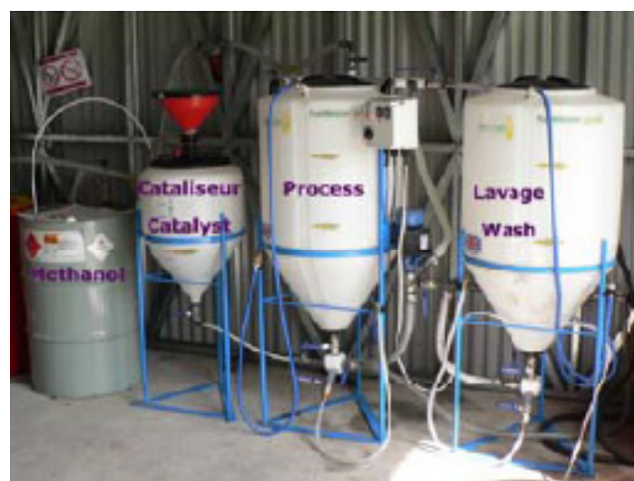
Photographie 62 : L'unité de production de biodiesel de Tagabé : capacité de production de 6 000 litres par mois
