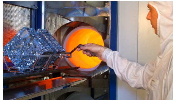
Photographie 41 : Fabrication de plaquettes de silicium
