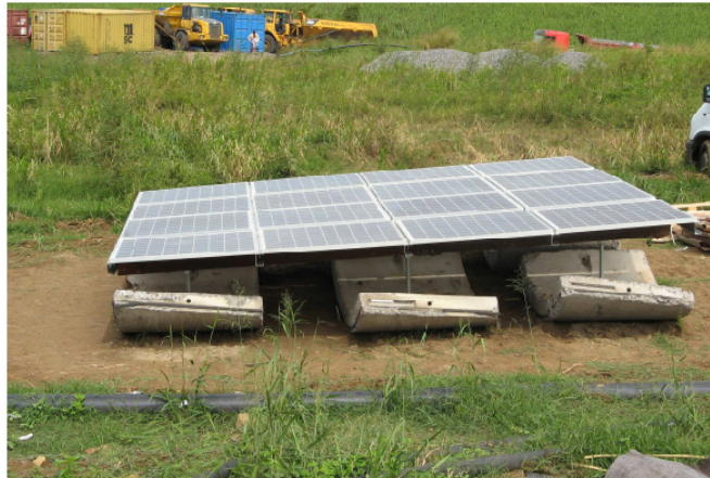
Structure porteuse de 16 modules type actuellement positionnée sur le CET afin d'obtenir des données précises d'ensoleillement
