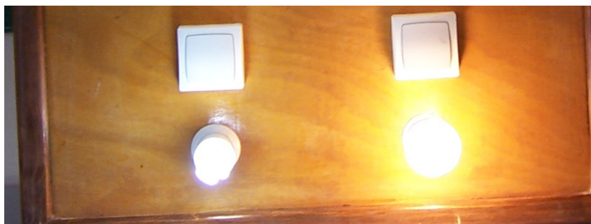
Photographie 33 : Efficacité lumineuse d'une LBC (à gauche) et d'une ampoule à incandescence (à droite)
