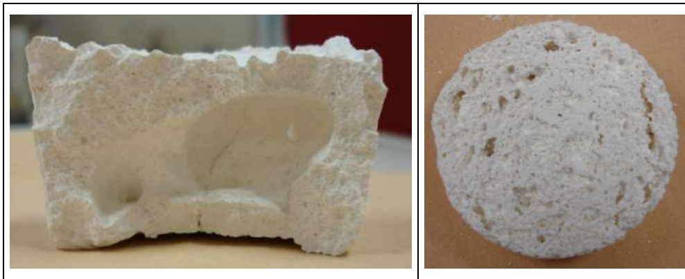
Figure 2-8 : coupes de mousses de silice montrant un défaut de séchage ; à gauche 48h à 40 °C en taille réelle, à droite 20 min au micro-onde, grandissement x 0,75.
