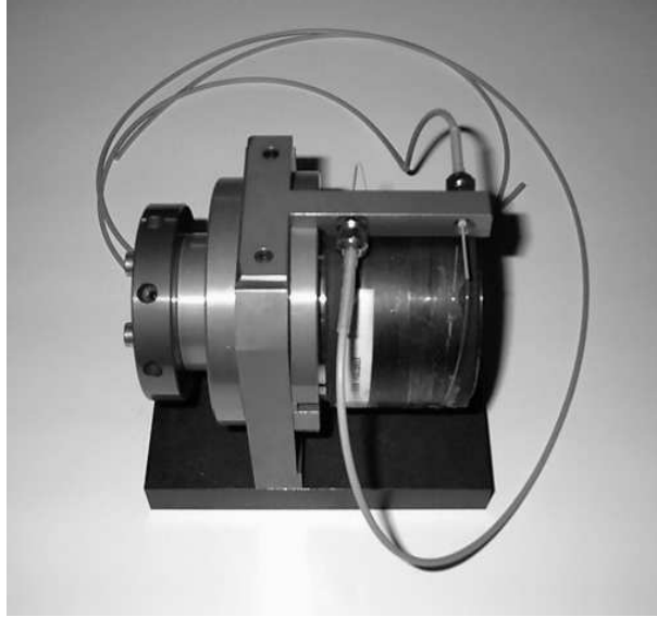
FIG. 5.10 – Photographie d'une ligne à retard fibrée.
