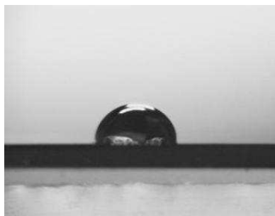
Fig. 10-1 : Profil d'une goutte d'eau ( V = 2,5 \mu\text{L} ) sur un réseau de microplots de 25 couches réalisés avec les buses de type II à partir d'une solution du type \text{Tf}_{0,05}\text{F}_{0,006}\text{E}_5\text{Et}_{20} .
