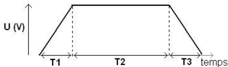
Fig. A-46 : Forme d'onde du pulse de sollicitation des buses de Type II.
