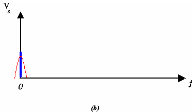
Figure 7: (a) Spectre du signal avant filtrage, (b) Spectre du signal après filtrage
