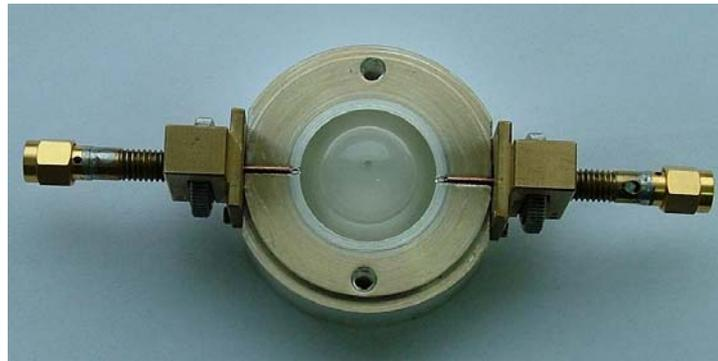
Figure 16 : Demi-sphère de Quartz et présentation des sondes utilisées pour les mesures
