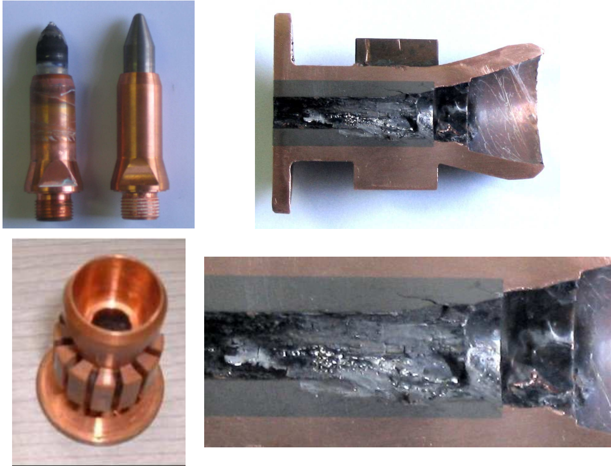
Figure III-1 : Etat d'usure des électrodes après 19 heures et 30 minutes d'utilisation.
