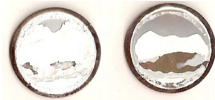
Figure IV-11 : (a) Dépôt de zircone, vitesse d'injection de 33,5 m/s, plasma Ar/He, I=700 A, h=19,6 MJ/kg, flux thermique sur le substrat de 16 MW/m 2 . (b) dépôt après avoir été soufflé avec de l'air comprimé.
