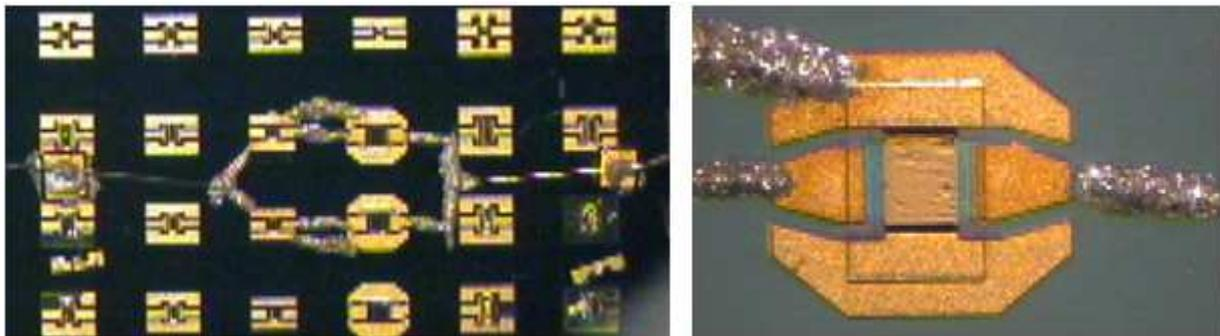
**Fig. II-24 : Connexion de plusieurs MEMS muni d'électrode inférieure avec la résine époxy.**
