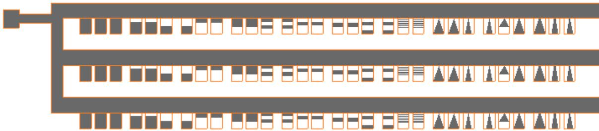
**Fig. II-48 : Masque destiné à évaluer l'influence de la répartition du chrome (en gris) sur l'allure et la tension d'actionnement des cantilevers.**
