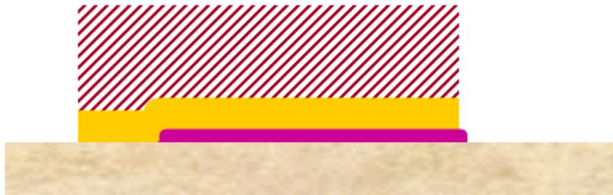
**Fig. II-41 : Gravure humide chimique pour la définition des ancrages et des poutres suspendues (masque2).**
