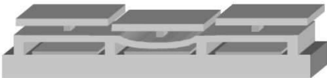
**Fig. I-18 :** Illustration de miroir à membrane segmentée.
