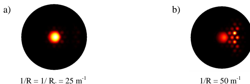
Figure II.62: Normes du champ électrique du mode fondamental pour des rayons de courbure de 4 cm (a) et 2 cm (b).
