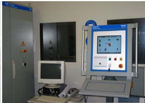
Figure II-9 : Vue d'ensemble avec à droite l'armoire de contrôle des gaz et à gauche le pupitre de contrôle du Multicoat
