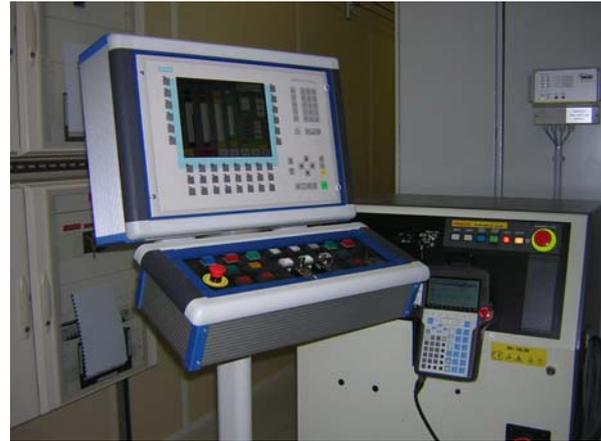
Figure II-13 : Pupitres de contrôle du procédé plasma et du robot 6 axes
