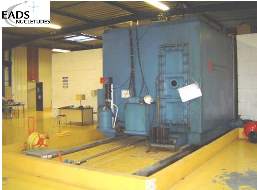
a – Balzac III : générateur d'impulsion \gamma de la société Nuclétudes
