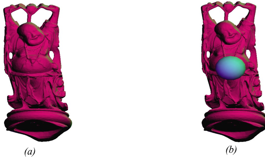
Fig. 5.1: (a) Avec élimination des parties cachées. (b) Sans élimination des parties cachées.
