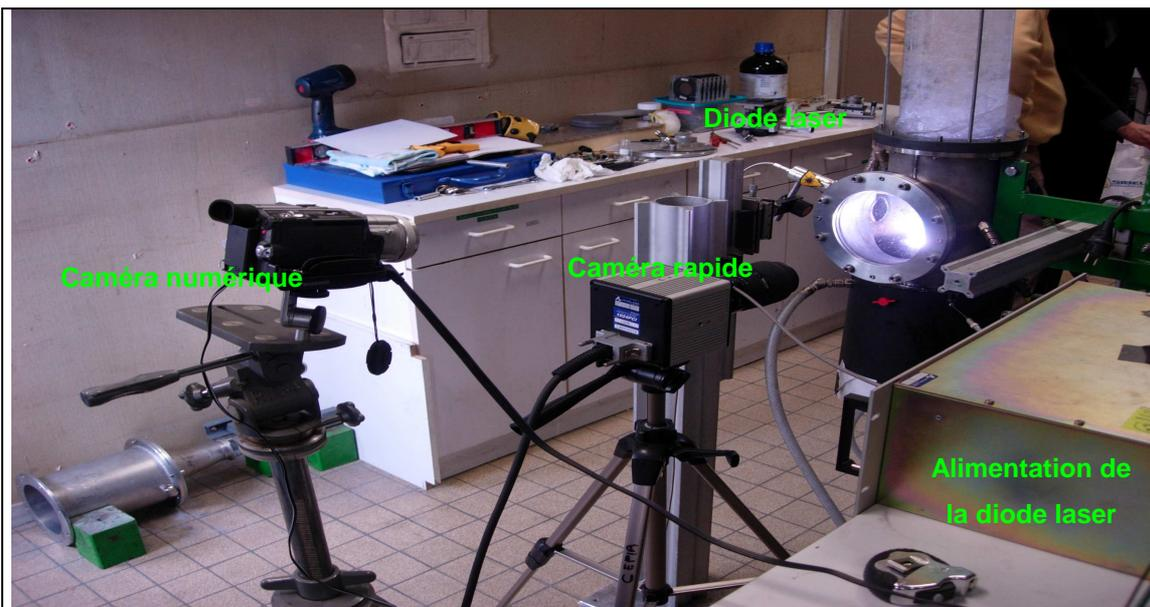
Figure II-25 : Le dispositif expérimental d'observation pour le jet de plasma immergé
