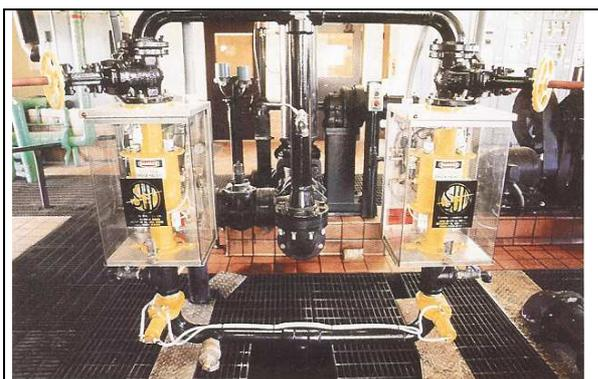
Figure I-11 : Pré-traitement de boues par arc électrique pulsé
