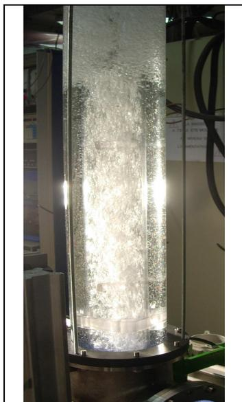
Figure IV-12 : Bouchon de bulles observé
