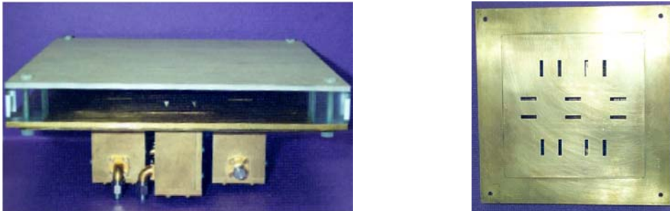
Figure 49 : Photo du prototype BIE multi-sources (vue de côté et vue de dessus des sondes d'excitation)
