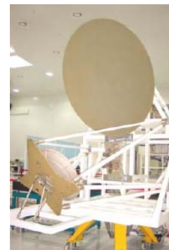
Figure 37 : Géométrie et photo d'une antenne à réflecteur de type Grégorien
