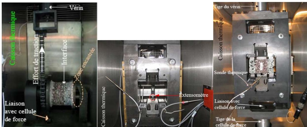
**Figure IV.3-3.** Eprouvette cylindrique ou prismatique mise en place sur le dispositif d'essai
