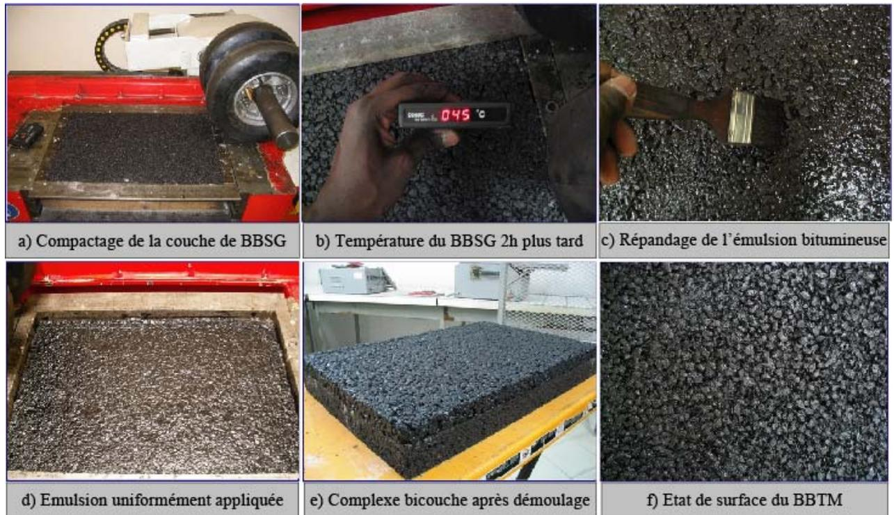
Figure IV.2-4. Phases de fabrication d'un complexe bicouche (BBSG et BBTM)
