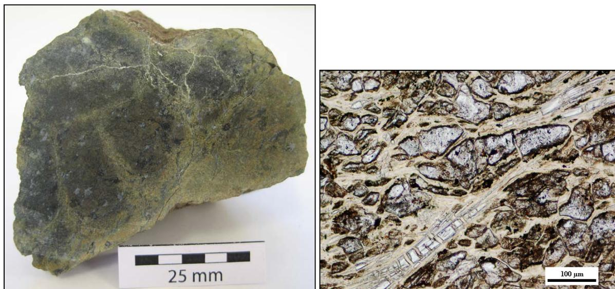
**Figure II.1.** Photographies de l'ultrabasite (photo à gauche – serpentinite prélevée au fond du profil de sol ; photo à droite – (microscopie optique) olivines entourées de l'iddingsite et des amphiboles fibreuses dans une matrice composée de minéraux du groupe des serpentines.
