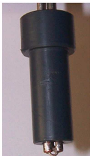
FIG. 2.17 – La sonde de puissance : une boucle formée à partir d’un câble RF unique
