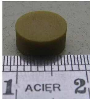
Figure III-41. Résonateur diélectrique réalisé en BZT par stéréolithographie.
