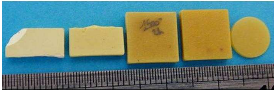
Figure III-38. Pièces en BZT fabriquées par stéréolithographie. La pièce de droite est le résonateur diélectrique de référence.
