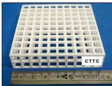
Figure I-60. [79] Cristal BIE 3D réalisé en alumine occupant une surface de 50 \text{ cm}^2 Copyright CTTC.
