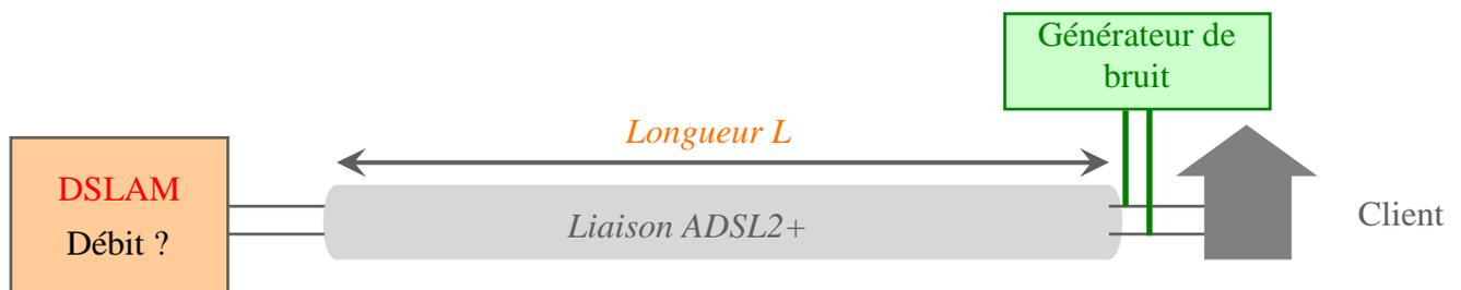
Figure III.19 - Gain en débit sur une liaison ADSL2+
