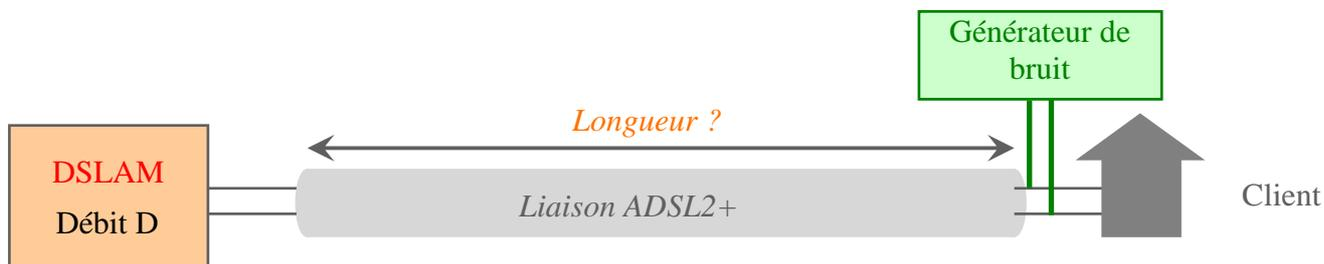
Figure III.20 - Gain en portée sur une liaison ADSL2+
