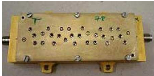
Figure I-13 : Capot supérieur de blindage contenant les vis de saphir
