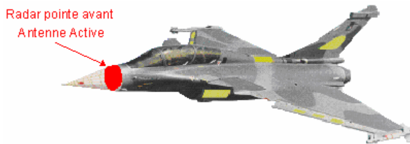
Fig 1.1 : Localisation de l'antenne active dans la pointe avant de l'avion de combat
