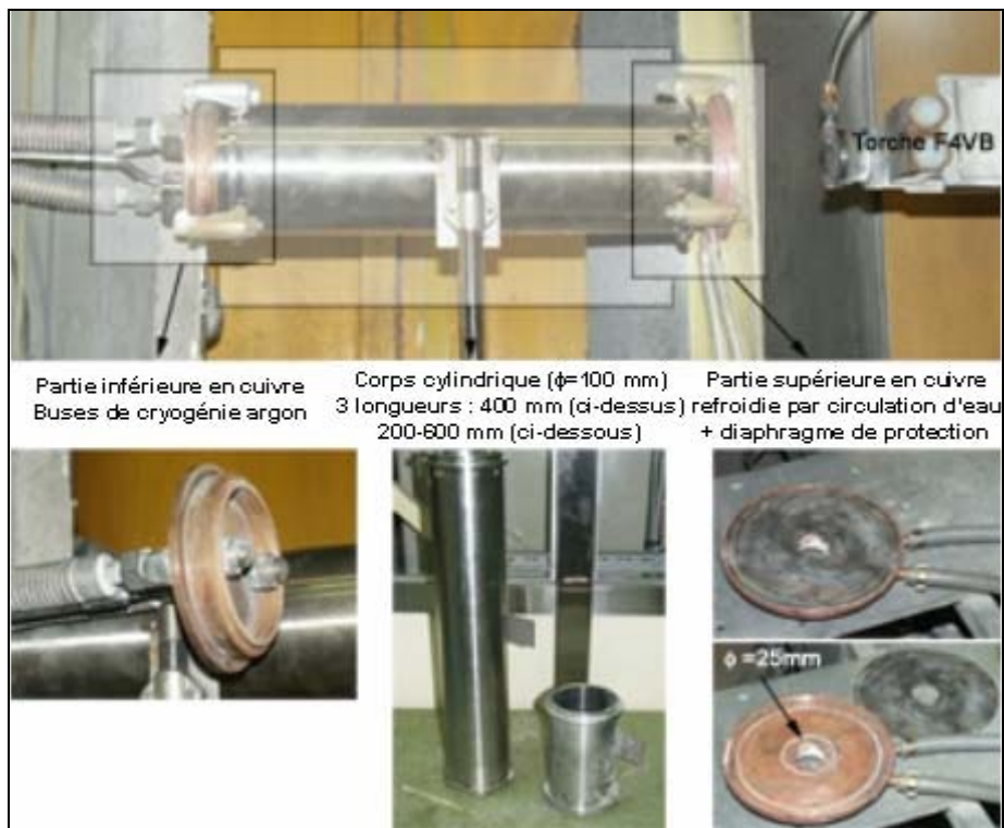
Figure III-3 : Dispositif expérimental pour la collecte des particules en vol.
