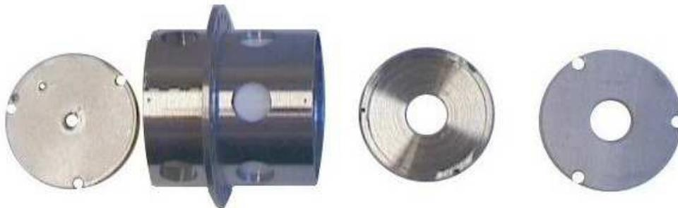
FIG. I.26 Photographie de la lentille électrostatique
