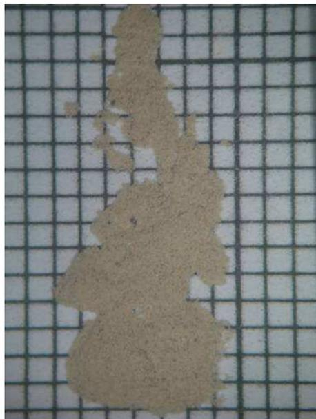
Figure 27 : Cendres volantes observées à la loupe binoculaire.
