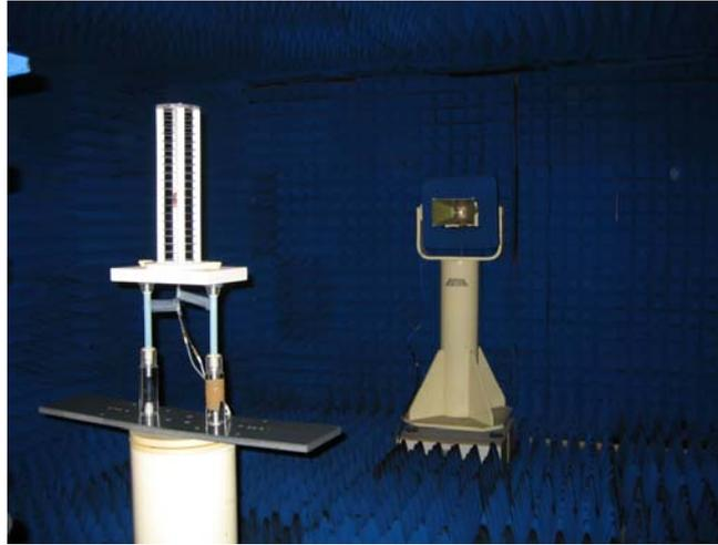
Figure II-35 : Mesure des diagrammes de rayonnement dans le plan horizontal sans radôme
