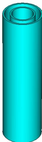
**Figure A2-1 : Antenne BIE cylindrique à matériau diélectrique**
