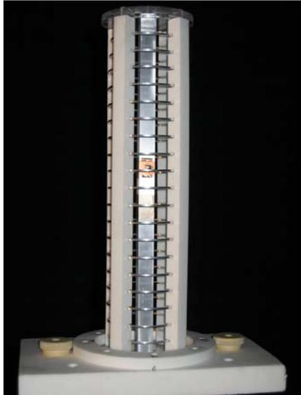
**Figure II-30: Antenne après modifications fixée sur le support de mesures**
