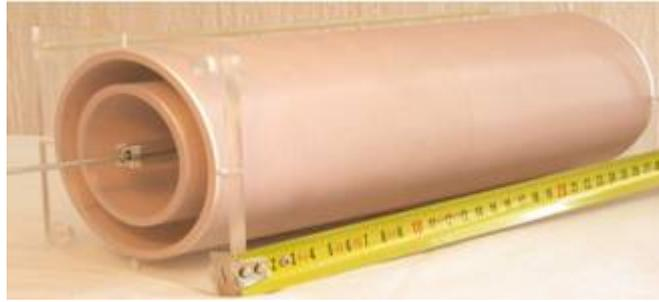
**Figure II-9: Antenne BIE diélectrique**
