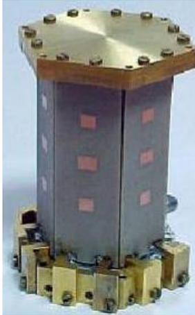
**Figure II-8: Agencement hexagonal de 6 réseaux de patches**
