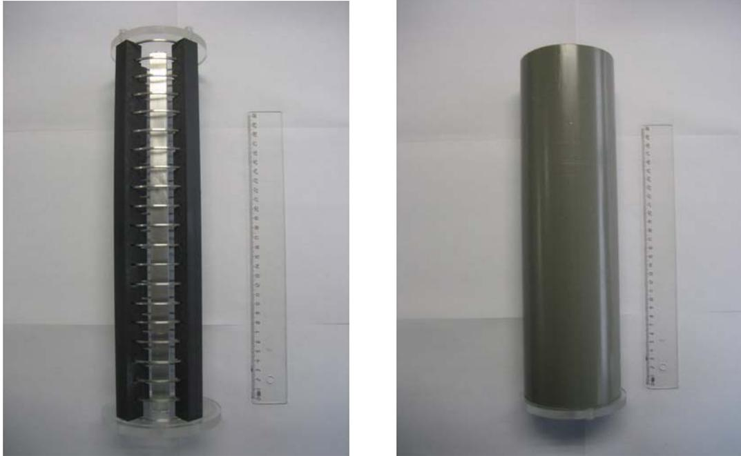
**Figure II-29 : Antenne réalisée par RADIALL avec et sans radôme en PVC**
