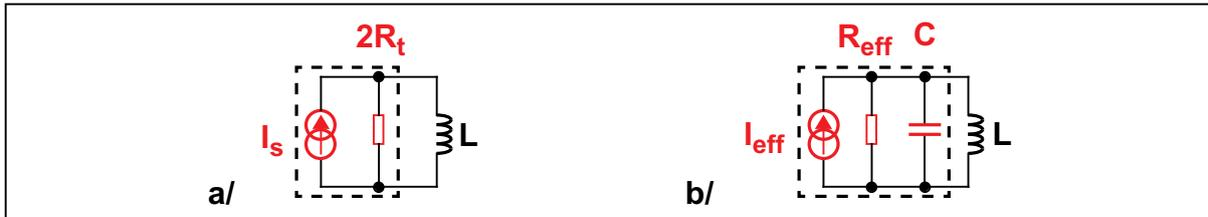
**Fig. IV.17: Circuit équivalent présenté par le filtre à l'inductance  $L$  a/ au voisinage du DC, b/ à la résonance**
