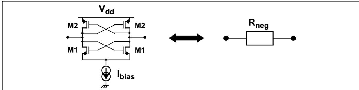
**Fig. IV.5: Structure de résistance négative**
