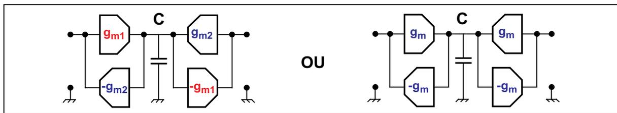
**Fig. IV.13: Inductance flottante avec transmission de puissance maximum**
