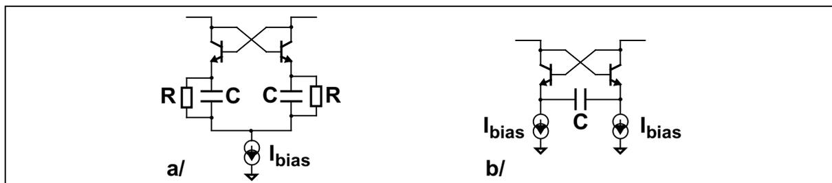
**Fig. IV.27: Transformateurs d'impédance négative avec capacité de dégradation**
