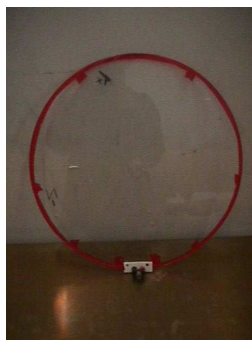
Figure 24 : Boucle magnétique pour mesurer les perturbations rayonnées
